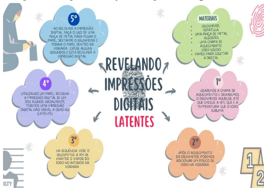
Figura 4 - Infográfico referente ao procedimento experimental para revelação de impressões digitais latentes
